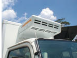
Кондензер преден монтаж
